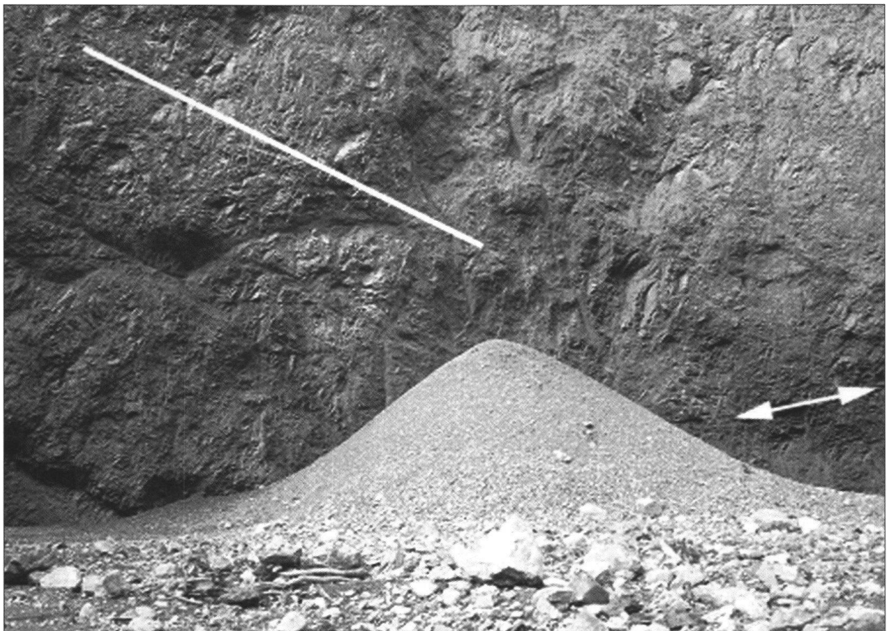
Fig. 2: Bergsturzmaterial im Versamer Tobel in «dreidimensionaler Puzzle Struktur». Die Bewegungsrichtung ist von rechts nach links. Am rechten Rand ist eine subhorizontale Schichtung zu erkennen (parallel weisser Pfeil). Bedeutende Bewegungen sind an nordfallenden, rampenartigen Scherbahnen erfolgt (parallel weisse Linie).
